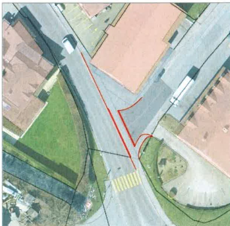
Figure 1 – Aménagement de type trottoir traversant
