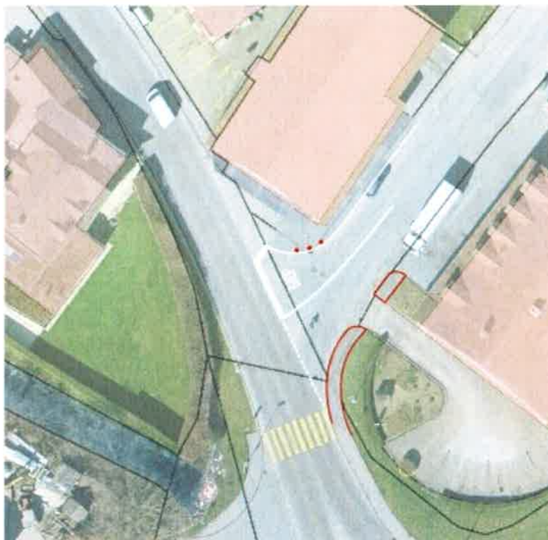
Figure 2 – Redimensionnement du carrefour et sécurisation
