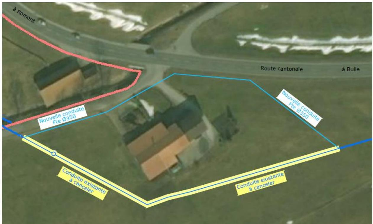
La nouvelle conduite sera en fonte, diamètre de 350 mm, pour une longueur d'environ 190 mètres.
